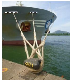
Figura 5 - Linhas de amarração no mesmo cabeço com olhais "encapelados"
