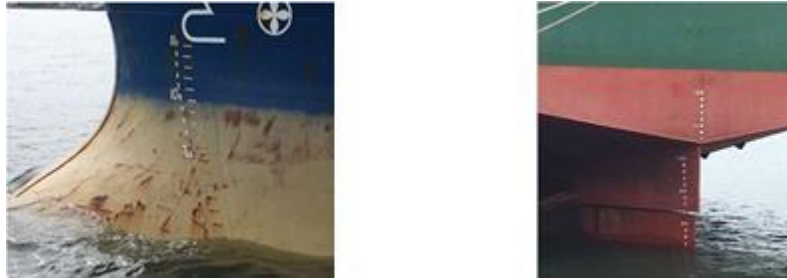
Figura 9 - Os calados de proa e de popa devem ser anotados tanto na atracação como na desatracação.
